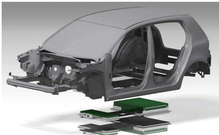
Konzeptstudie einer leichtbauoptimierten Fahrzeugkarosserie der C-Klasse mit integriertem Energiespeichersystem (© Fraunhofer LBF).
