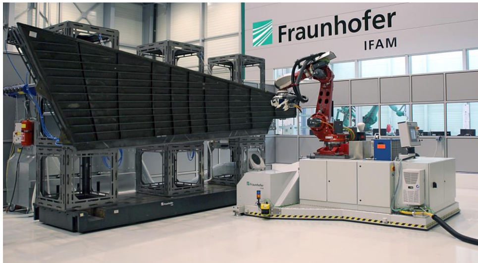
ProsihP II-Gesamtanlage zur Bearbeitung eines A320 Seitenleitwerkes. © Fraunhofer IFAM
