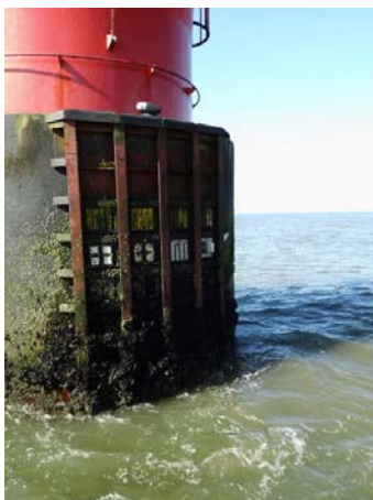
Abb. 2: Korrosionsproben im küstennahen Schifffahrtsbereich am Leuchtturm »Alte Weser«. © Fraunhofer IFAM
