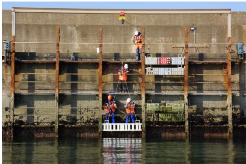
Abb. 1: Betrieb des Freibewitterungsprüfstands an der Helgoländer Westmole. © Fraunhofer IFAM
