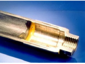
Abb. 5 Verbinden von Spezialwerkstoffen mit thermischer Null-Ausdehnung 4
