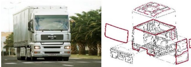
Abb. 20 Klebtechnik im Nutzfahrzeugbau: die GFK-Außenelemente der Fahrerkabine sind geklebt (Bild links)/ die roten Linien verdeutlichen die Klebnähte (Bild rechts)
