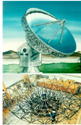
Abb. 4 Submillimeter-Radioteleskop mit hochpräzisem Parabolspiegel (Modell, oben) / Verbindung von Invar (Knotenpunkte) mit CFK-Rohren (unten)
