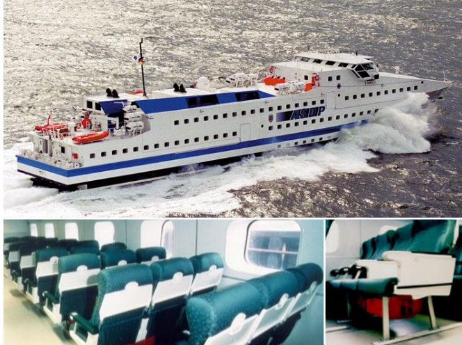
Abb. 23 Schiffbau – die Passagierfensterscheiben aus Polycarbonat und die Sitzreihen (Bilder unten) sind eingeklebt
