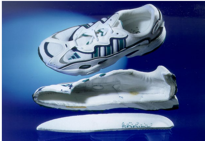
Abb. 31 Klebtechnik in der Schuherstellung – geklebter Lami- nataufbau eines Sportschuhs 4
