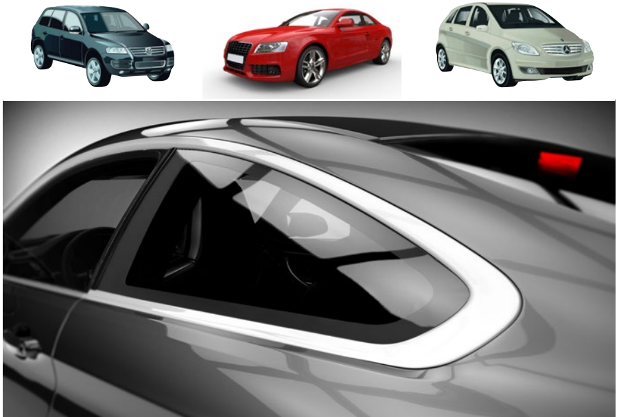
Abb. 18 Klebtechnik – aus dem modernen Automobilbau nicht mehr wegzudenken: Scheibenkleben im modernen Automobilbau (unten) ist Stand der Technik
