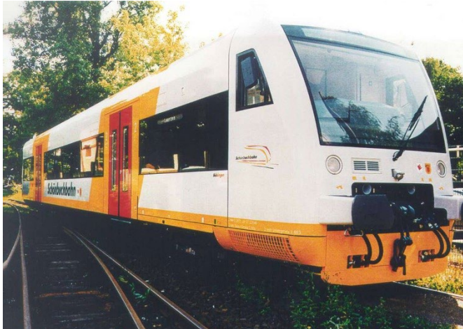
Abb. 47 RegioShuttle – Einsatz von GFK im Außenbereich: Leichtbau durch Klebtechnik 179,180
