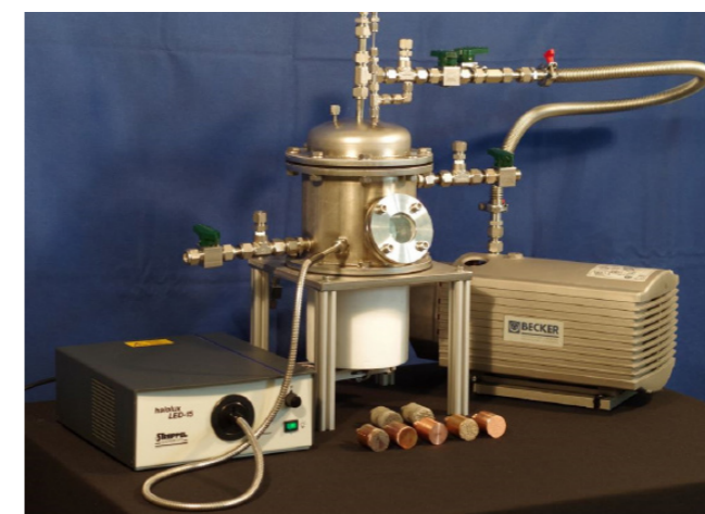
Versuchsstand zur Evaluierung des verbesserten Wärmeüberganges an strukturierten Verdampferoberflächen
