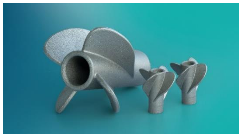
Abbildung 8: Abbildung des gedruckten Duplex-Demonstrators (Groß: 75er Mischung; Klein: 60er Mischung)
