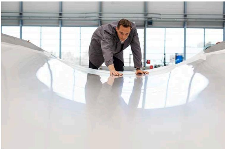
FlexPlas®-Trennfolie nach dem Tiefziehen in eine doppelt gekrümmte Form.
