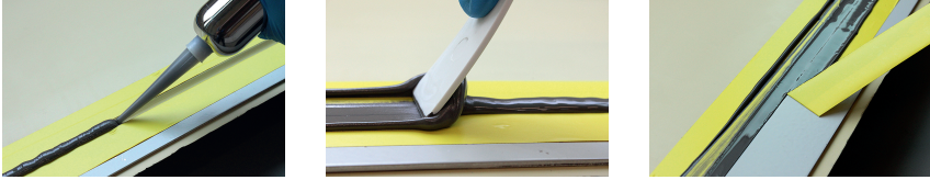
Bild 2: Manuelle Dichtstoffverarbeitung mit Materialauftrag, Formgebung und Demaskierung
