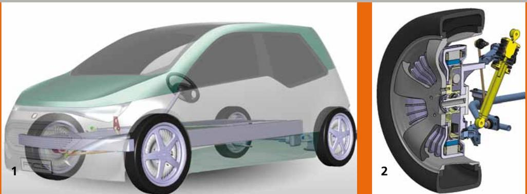
1 Fahrzeugkonzept mit vier Radnabenmotoren.
