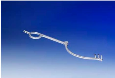
Studie einer Branche eines chirurgischen Wundspreizers mit integrierten Spülkanälen und Anschlußstück. Generativ gefertigt aus Edelstahl 17-4 PH / 1.4542. Oberfläche geschliffen und händisch poliert. (© Fraunhofer IFAM)
