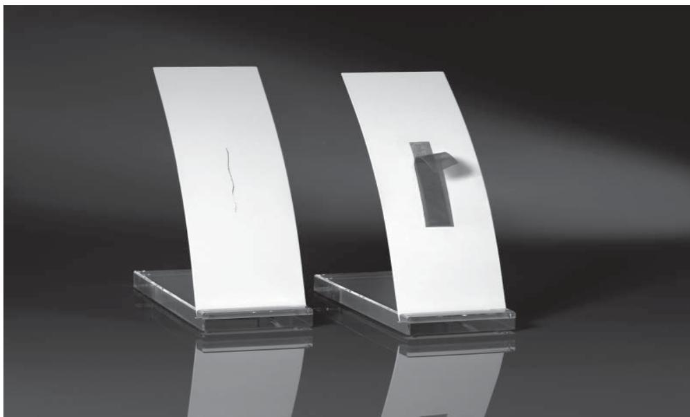
**Anwendung des Beizklebebands vor der Reparatur eines Lackschadens. Der Lack wird durch Schleifen entfernt, das Beizband zur Vorbehandlung der Metalloberfläche aufgebracht. Nach dem Abziehen des Klebebands und einer kurzen Reinigung mit einem feuchten Tuch kann die Oberfläche neu lackiert werden. (© Fraunhofer IFAM) | Bild in Farbe und Druckqualität: [www.fraunhofer.de/presse](http://www.fraunhofer.de/presse)**
