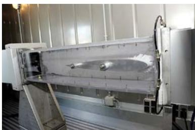
Testfeld mit integriertem Flügelprofil im Vereisungswindkanal am Fraunhofer IFAM © Fraunhofer IFAM
