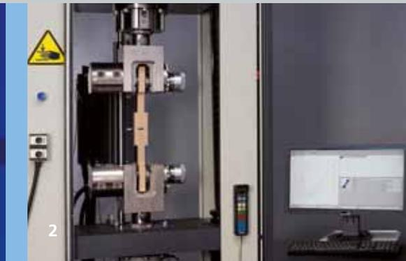
**1 Klebtechnik:** Kleine Proben charakterisieren die Holzfestigkeit, mittlere Zugscherproben ermöglichen die Klebstoffauswahl und große Probekörper verifizieren die Ergebnisse am Bauteil.
