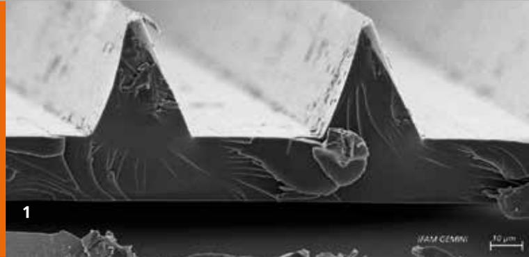
1 Rasterelektronenmikroskopische Aufnahme einer ribletstrukturierten Lackoberfläche.
