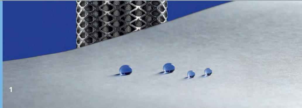
1 Filtermaterial mit verbesserter Chemikalienbeständigkeit und erhöhter Lebensdauer durch ultradünne plasmapolymere Beschichtung.
