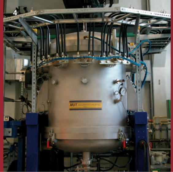
Betrieb unter Hochvakuum mit Endvakuum besser  $5 \times 10^{-6}$  mbar für hochreine Anwendungen wie beispielsweise Titansinterungen; komplett ölfreier Vakuumpumpsatz, Anlage mit Argon und Helium flutbar für sauerstoffarmen Probenwechsel.
