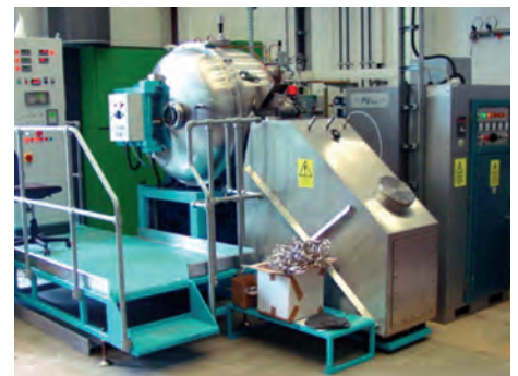
Rascherstarrungsanlage am Fraunhofer IFAM
