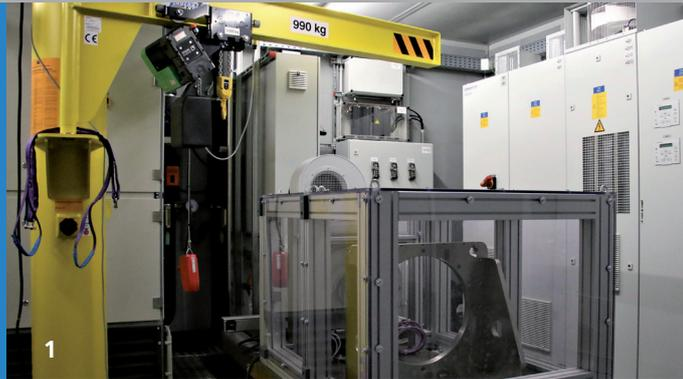
1 Motorprüfstrang mit Schutzeinrichtung.
