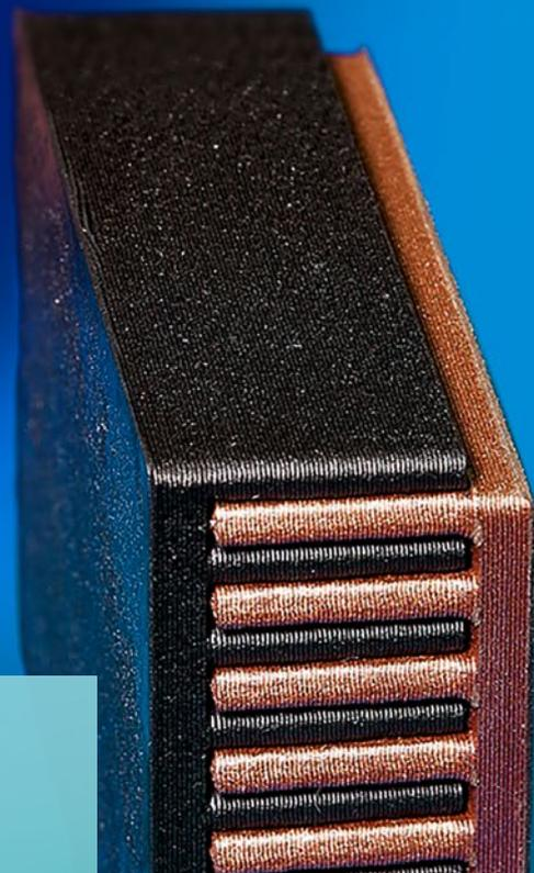
3D-Druck mit thermisch hochleitfähigem Polymerkomposit.
