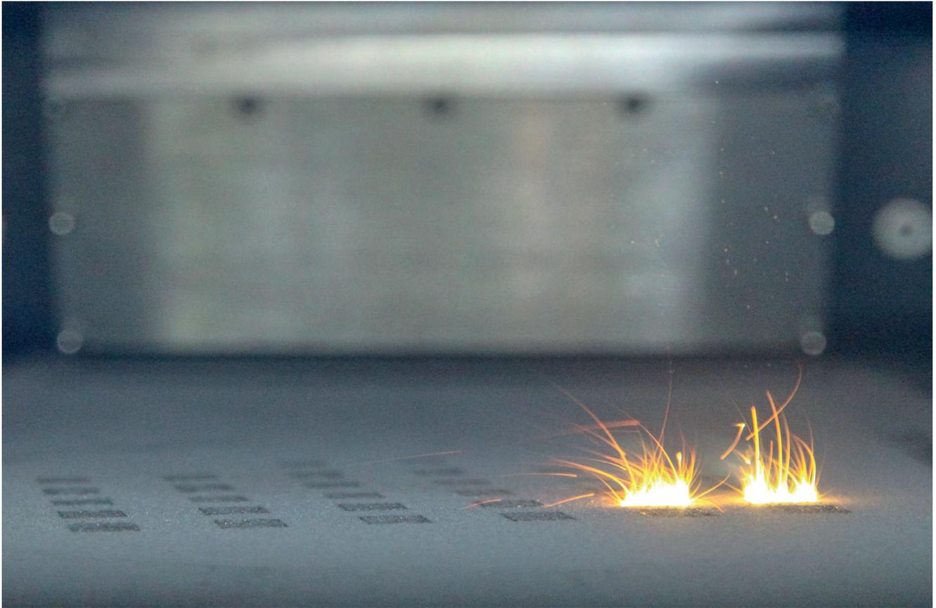
Lokales Aufschmelzen der feinen Pulverschicht beim Laser Powder Bed Fusion-Prozess.
