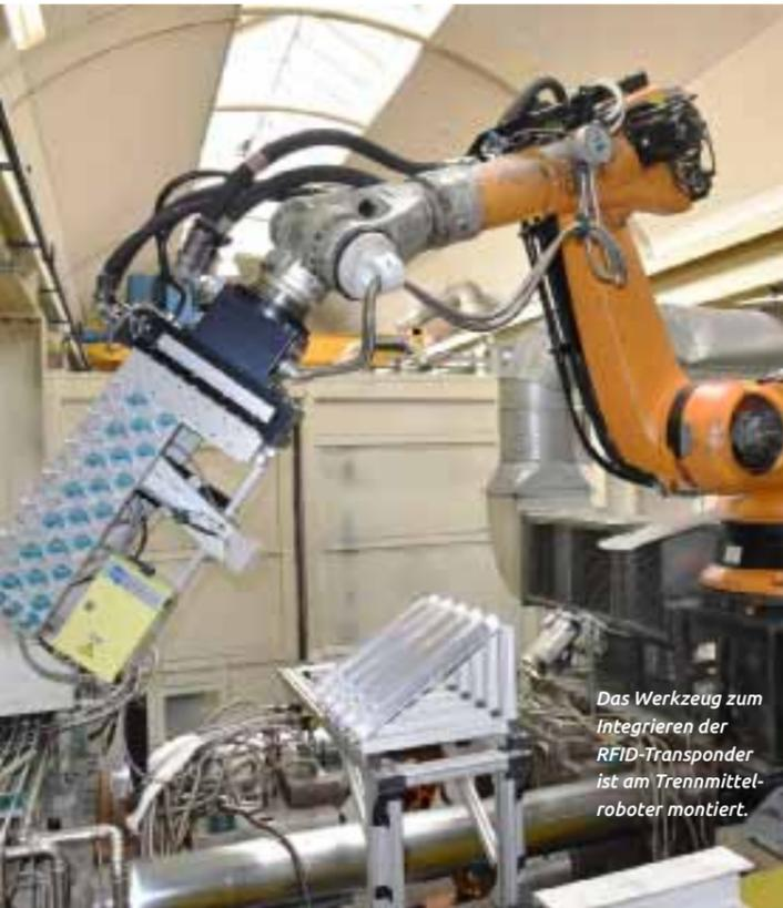
Das Werkzeug zum Integrieren der RFID-Transponder ist am Trennmittelroboter montiert.
