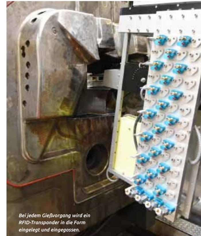
Bei jedem Gießvorgang wird ein RFID-Transponder in die Form eingelegt und eingegossen.
