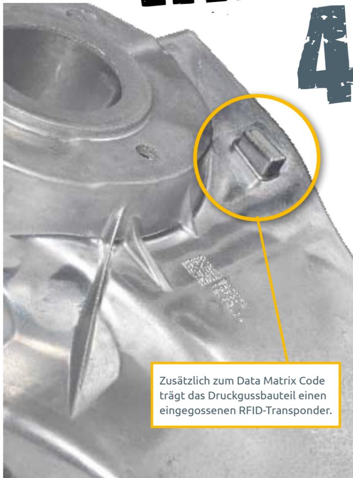
Zusätzlich zum Data Matrix Code trägt das Druckgussbauteil einen eingegossenen RFID-Transponder.
