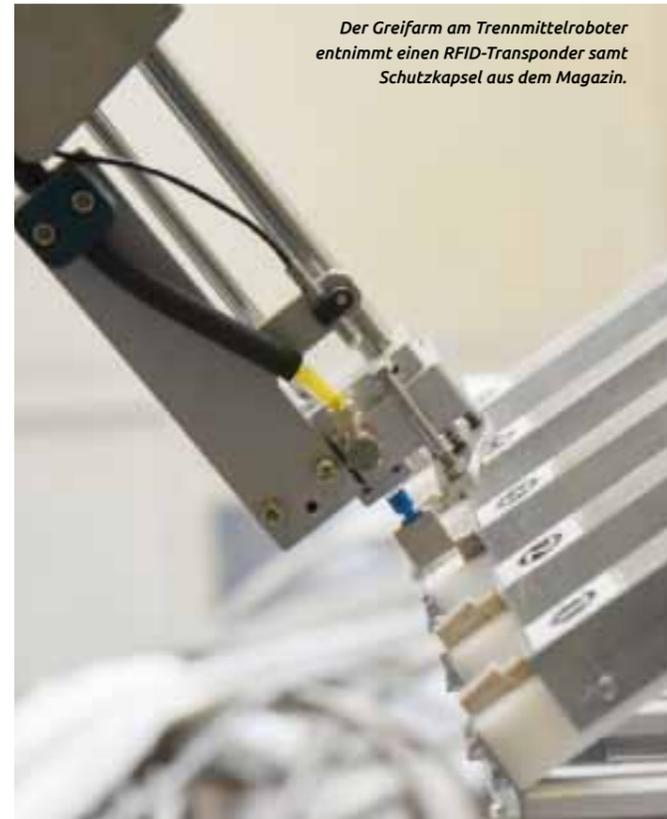
Der Greifarm am Trennmittelroboter entnimmt einen RFID-Transponder samt Schutzkapsel aus dem Magazin.
