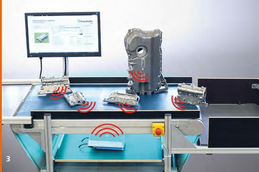
reichend, wird die im metallischen Bereich bislang vorherrschende, robuste Systemfrequenz 125 kHz (LF) eingesetzt. Mit Anwendung der 868 MHz (UHF) wird derzeit der nächste Technologieschritt gegangen, um die Lesereichweite für Gussbauteile mit integriertem RFID-Transponder auf bis zu einem Meter zu erhöhen.
