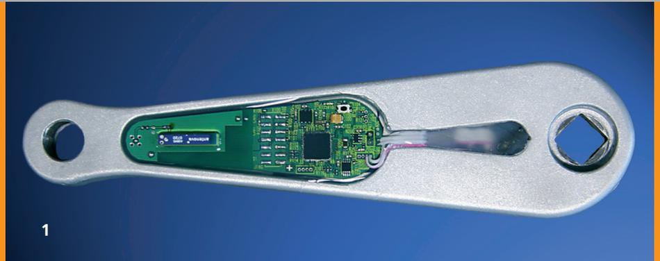
1 Druckguss-Tretkurbel mit integrierter Piezosensorik zur Messung von Druck- und Zugkräften.
