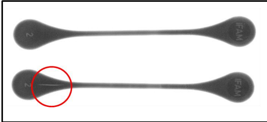
Bild 6: Röntgendurchstrahlung eines Zugstabes nach ISO 2740; fehlerloses Grünteil (oben), fehlerhaftes Grünteil (unten)
