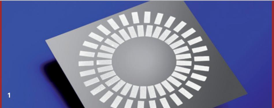
1 *Gedruckte magnetische Nonius-Struktur zur Drehzahl- und Positionsmessung.*
