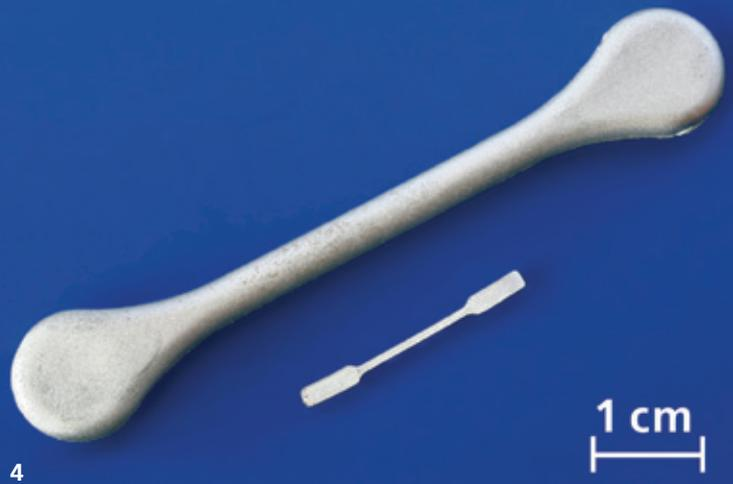
Nach diesem Formgebungsschritt werden die Binderkomponenten aus den entstandenen Bauteilen mittels einer Lösemittel- und/oder thermischen Entbinderung wieder entfernt. In einem weiteren thermischen Prozessschritt wird die Metallmatrix verdichtet (gesintert). Das MIM-Verfahren erlaubt, syntaktische Stahl- bzw. Eisenschäume mit komplexen Geometrien kostengünstig in Serie zu realisieren.
