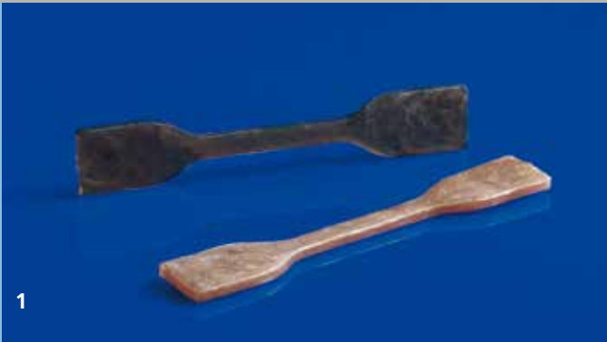
1 Spritzgegossene Zugstäbe aus Chitosan.
