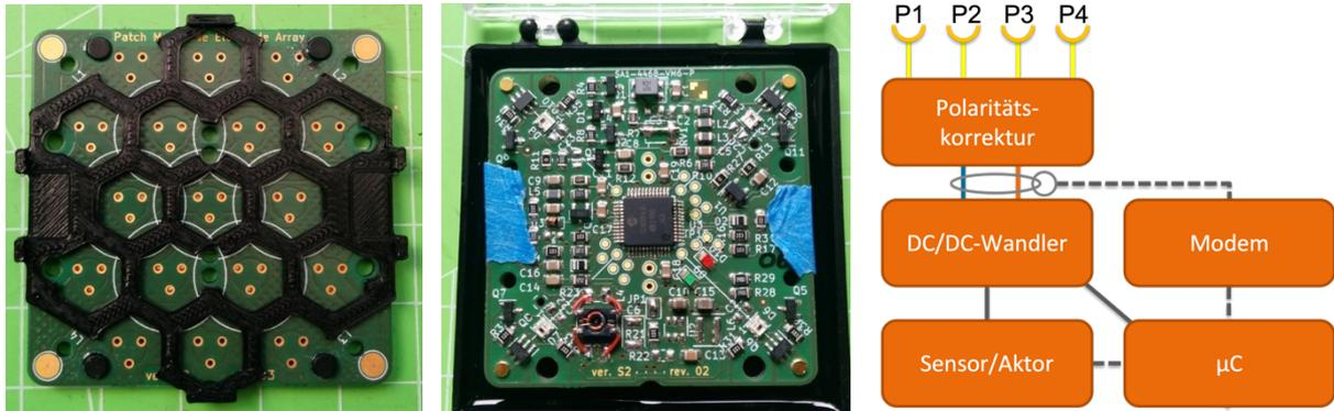
Abbildung 22 Elektrodenraster, Elektronikmodul und Blockdiagramm der darin enthaltenen Komponenten
