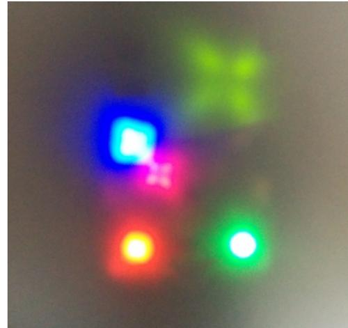
*Abbildung 2 Diffusionsschichten aus milchigem Acryl (links) und spezieller Streuungsfolie (rechts). Die Wirkung wird durch die Kamera nicht ganz akkurat wiedergegeben*
