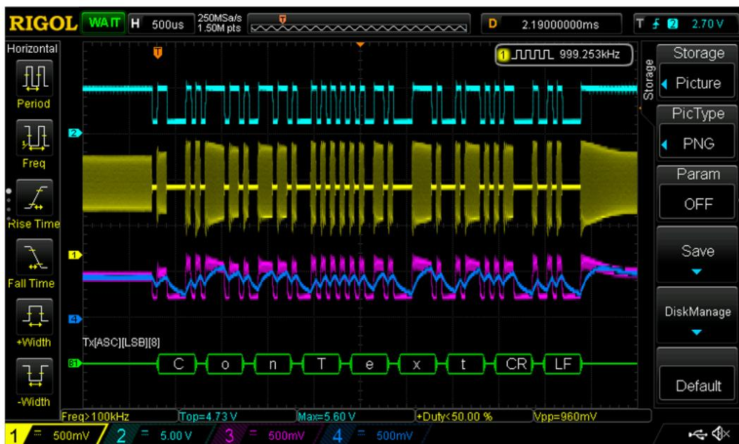
Abbildung 25 Demodulation und -codierung eines empfangenen Signals, gemessen an echter Hardware
