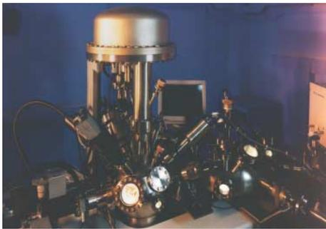
Abb. 1: Röntgenphotoelektronen-Spektroskopie (XPS) zur Oberflächenanalyse.
