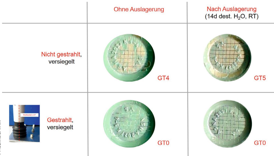
Bild 4 > Gitterschnitt-Testergebnisse an unbehandelten beziehungsweise gestrahlten und versiegelten Verbindungselementen vor und nach Auslagerung.
