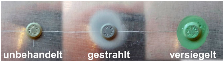
Bild 6 > Nietkopf im unbehandelten Zustand, gestrahlt und versiegelt.
