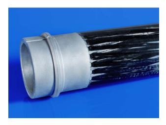
Rohrstoß als Hybridverbindung zwischen einem Aluminium-Druckgussbauteil und CFK mithilfe von Titandrahtschlaufen als Übergangsstruktur (© Fraunhofer IFAM).
