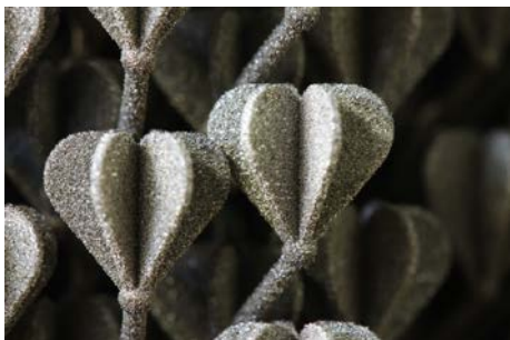
Generativ gefertigte Segmente des Kühlsystems. (© Fraunhofer IFAM/Thorsten Müller)
