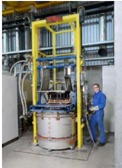
Gießversuch mit gasbeheizter Kokille. © Fraunhofer IFAM
