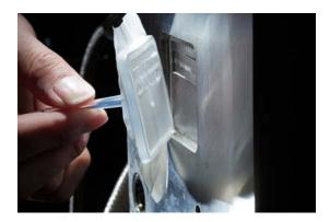
Entnahme eines spritzgegossenen Versuchsbauteils unter Verwendung der flexiblen Trennfolie (© Fraunhofer IFAM/Wolfgang Hielscher)
