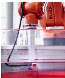
Ultraschall-Prüfung von CFK. © Uwe Bellhäuser
