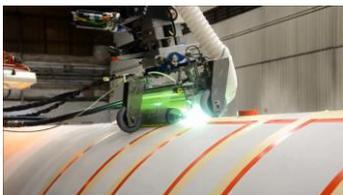
Automatisierte Beschichtung des Riblets-Lacks auf Rotorblättern. © Fraunhofer IFAM
