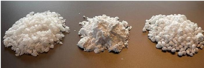
**Abb. 2 Vom PCL (links) zum Komposit (rechts) gefüllt mit bioaktivem Glas (Mitte).**
