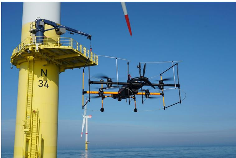
UAS-Einsatz zur Inspektion einer Offshore-Windkraftanlage im Rahmen des Forschungsprojekts AIDA. Gefördert durch das Bundesministerium für Wirtschaft und Klimaschutz aufgrund eines Beschlusses des Deutschen Bundestages, FKZ: 03EE3057A. © Fraunhofer IFAM
