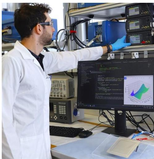
**Abb. 1** Laboraufbau zur computergestützten Echtzeit-Impedanzmessung an einer Lithium-Ionen-Batteriezelle zur Analyse des Zustands
