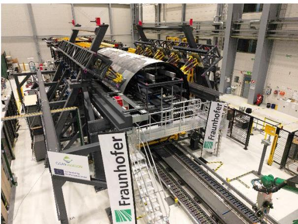
**Abb. 1 Montage-Forschungsplattform mit thermoplastischen Rumpfschalen des »MFFD« am Fraunhofer IFAM in Stade**
