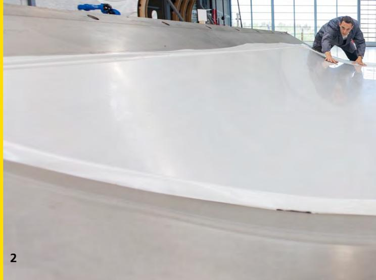
muss – gegenüber der bisherigen Lösung mit aufgespritzten Trennmitteln ein Quantensprung. Die Technologie für diese Anwendung haben die PLATO-Wissenschaftler in jahrelanger Arbeit bis zur Einsatzreife vorangetrieben.
