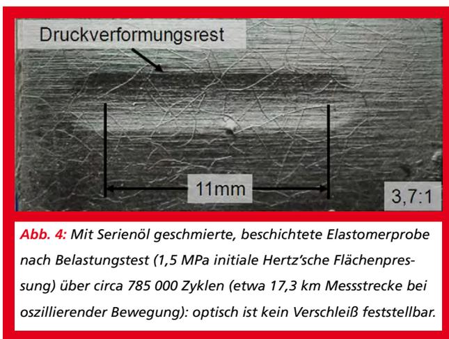
**Abb. 4:** Mit Serienöl geschmierte, beschichtete Elastomerprobe nach Belastungstest (1,5 MPa initiale Hertz'sche Flächenpressung) über circa 785 000 Zyklen (etwa 17,3 km Messstrecke bei oszillierender Bewegung): optisch ist kein Verschleiß feststellbar.
