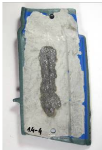
Abb. 63: Beschichtete Proben (je 2 Parallelproben Bauteilseite „links“ und „rechts“) AM 50 nach 500 h Salzsprühnebeltest nach DIN EN ISO 9227 (NSS) in Abhängigkeit vom verwendeten Trennmittel Oberflächenvorbehandlung: Konversionsschicht Gardobond X 4707 (Variante 2, s. o.)
