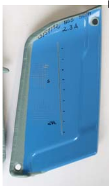
Abb. 64: Beschichtete Proben (je 1 Probe Bauteilseite „links“ und „rechts“) AM 50 nach 500 h Salzsprühnebeltest nach DIN EN ISO 9227 (NSS) in Abhängigkeit vom verwendeten Trennmittel Oberflächenvorbehandlung: Beizen Phosphorsäure (Variante 3, s. o.)
