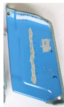
Abb. 64: Beschichtete Proben (je 1 Probe Bauteilseite „links“ und „rechts“) AM 50 nach 500 h Salzsprühnebeltest nach DIN EN ISO 9227 (NSS) in Abhängigkeit vom verwendeten Trennmittel Oberflächenvorbehandlung: Beizen Phosphorsäure (Variante 3, s. o.)
