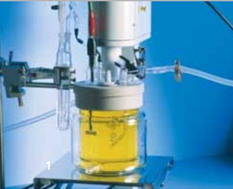
1 *Messplatzaufbau am Fraunhofer IFAM Bremen (Fa. Jaissle / Ing.-Büro P. Schrems) für konventionelle elektrochemische Untersuchungen mit Rotierender Scheibenelektrode.*
