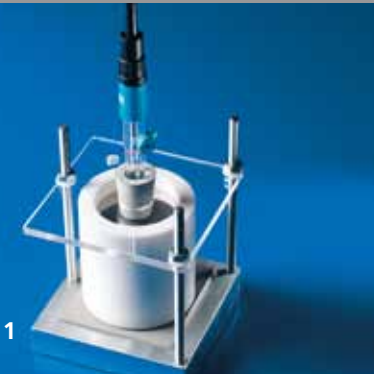
1 Aufsatzmesszelle für die EIS und Proben einer Aluminiumlegierung mit beschädigter organischer Beschichtung.
