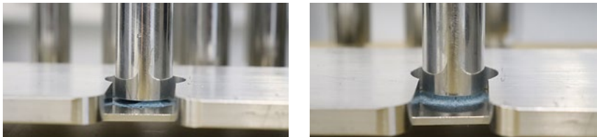
Bild 2: Stirnabzugversuche mit unzureichender (links) und guter Oberflächenhaftung (rechts)
