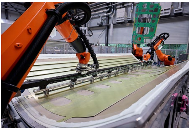
Bild 4: Der 6 m lange Stringergreifer wird von zwei kooperierenden Industrierobotern geführt (Bild: Fraunhofer IFAM)
