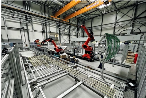
Bild 5: Blick auf die Automatisierungszelle mit der Stringer-Bereitstellungseinheit (im Vordergrund) und Industrierobotern zum Bauteilhandling (im Hintergrund)
