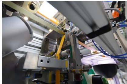
Bild 3: Schematische Funktionsweise der Klebfilmaufbringung (links) und reale Klebfilmapplikation auf den Stringer (rechts) (Bild: Fraunhofer IFAM)
