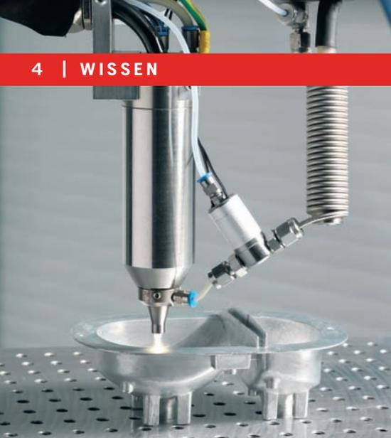
»2 Atmosphärendruckplasma wird zur Reinigung, Aktivierung und Beschichtung von Bauteiloberflächen in den industriellen Serienprozess integriert
