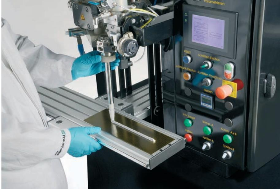
»4 In der Erprobungsphase werden Charakteristika von Dosieranlagen und Klebstoffen aufeinander abgestimmt sowie Prozessgrenzen ermittelt
