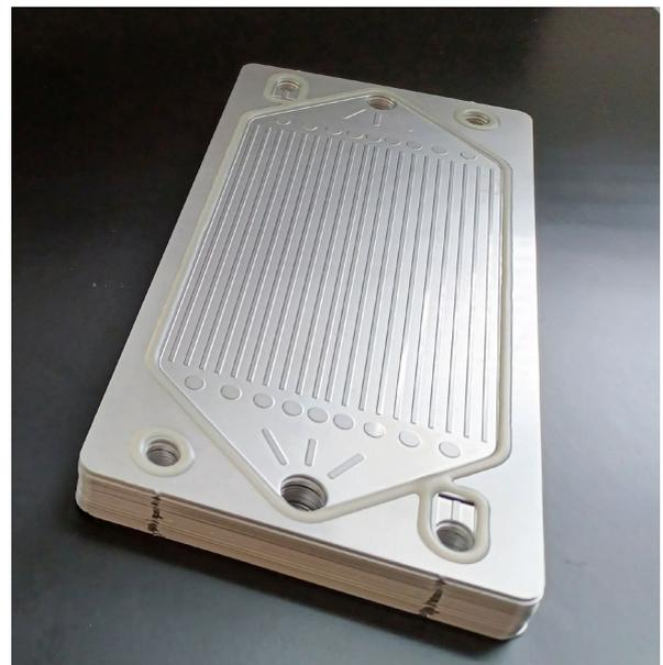
**Bild 3** > Durch UV-Strahlung initiierte Aushärtung einer einseitig applizierten "Cure-in-Place"-Dichtung auf der Kühlseite einer Bipolarplatte
