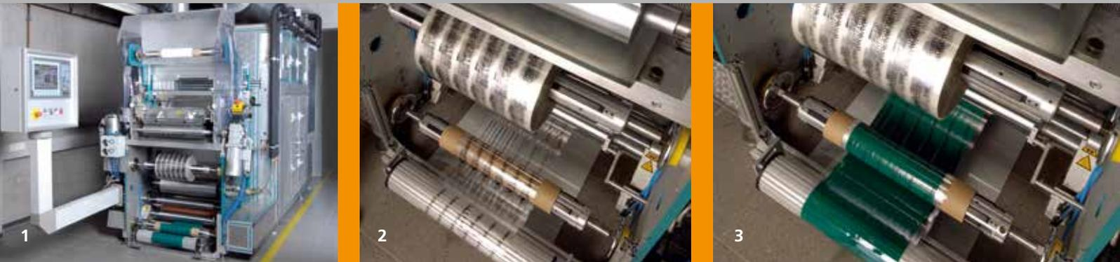
1 Technikumsanlage zum flächigen Beschichten und Kleben.
