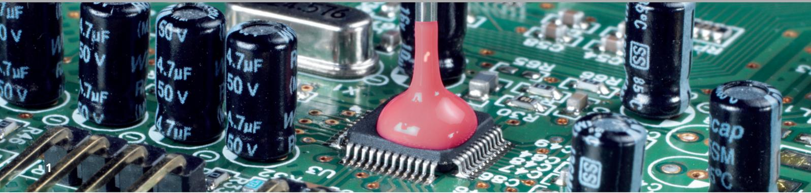
1 Vergießen eines elektronischen Bauteils.
