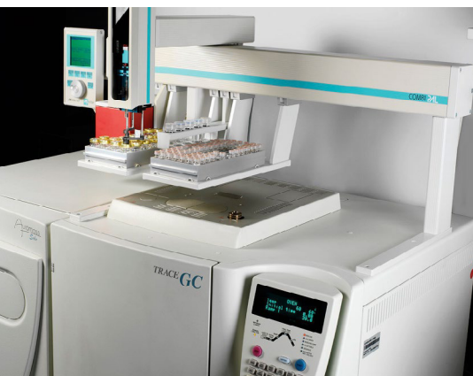
Bild 8 > Probenpräparation – rechts: Extraktion nach PV 3055 (1 g Silikon auf 10 ml Heptan), links: Emission nach PV 3040 unter Standardbedingungen (50 mg Silikon auf 20 ml Gasvolumen)
