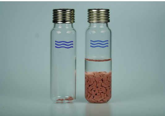
Bild 8 > Probenpräparation – rechts: Extraktion nach PV 3055 (1 g Silikon auf 10 ml Heptan), links: Emission nach PV 3040 unter Standardbedingungen (50 mg Silikon auf 20 ml Gasvolumen)
